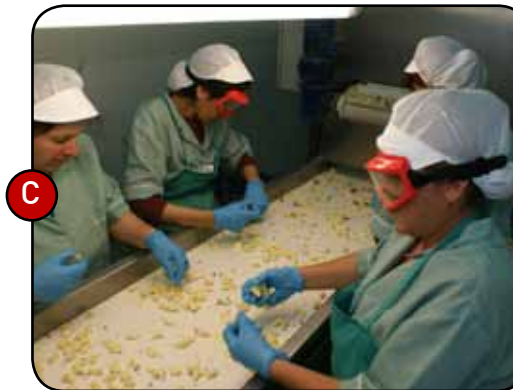
С. Стол для контроля качества. Операторы просматривают уже очищенные зубки чеснока и удаляют поврежденные и низкого качества.
