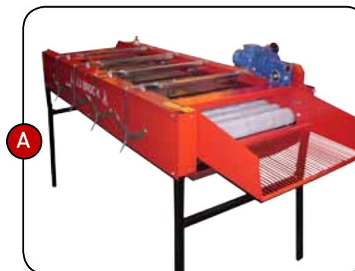
А. Щетки с рабочей площадью в 3 метра сверху и снизу. Эффективное удаление грунта и поверхностной загрязненной шелухи с головок чеснока.
