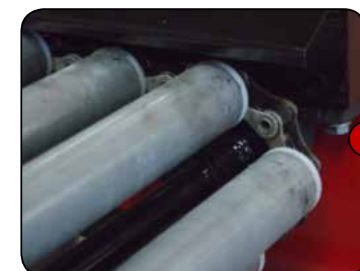
Ф. Диаметр рабочих роликов обеспечивает постоянную ротацию головок чеснока, улучшая его очистку и контроль. Дополнительно между роliками можно установить стальные прутья для сокращения пространства.
