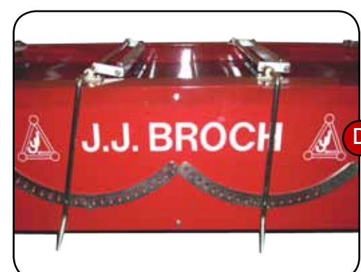
Д. Простая регулировка верхних плит щеток
