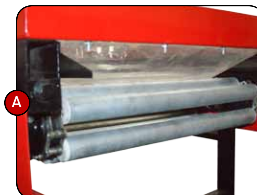
А. Гибкий полиэтиленовый лист позволяет выгрузку головок чеснока без повреждений и ударов.
