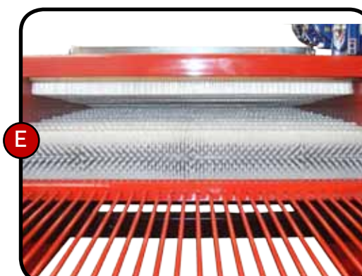
Е. Синтетические волокна щеток специально для чеснока обеспечивают отличную ротацию головок и гарантируют их бережную очистку, без повреждений.
