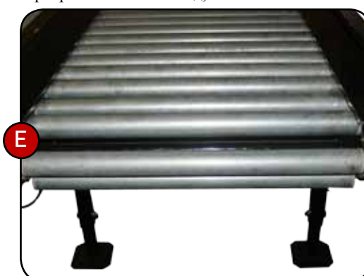
Е. Рабочая ширина до 750 мм позволяет обрабатывать большой объем продукта до 8 тонн / час
