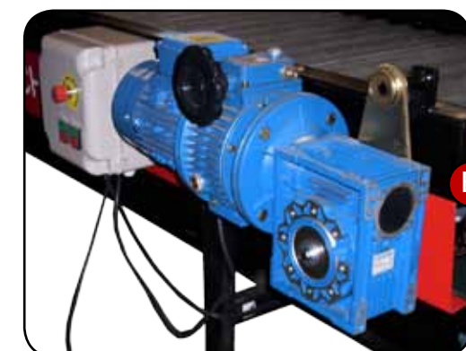
В. Ролики приводятся в движение при помощи электромотора мощностью 1 кв. Скорость работы регулируется в зависимости от качества поступаемого с поля чеснока.
