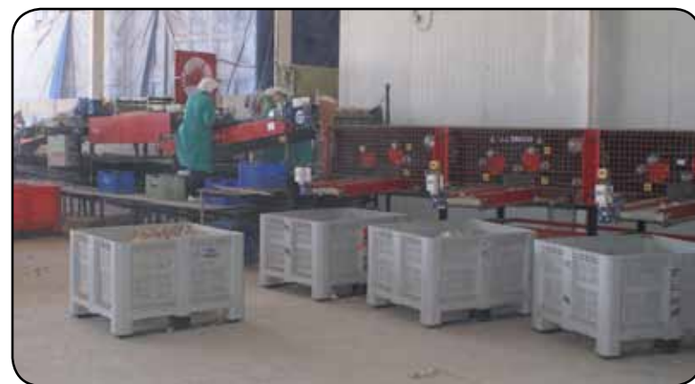
Полная линия приемки и очистки. Приемный бункер – Роликовый стол-Шелушильный стол-Сортировщик
