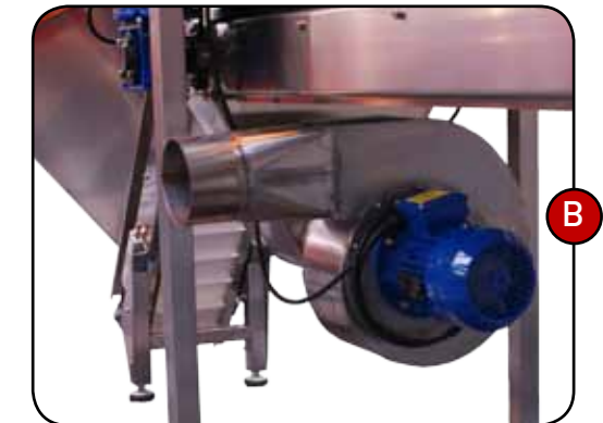
В. Удаление отходов. Удаление шелухи и оболочки посредством пневматической вытяжки.
