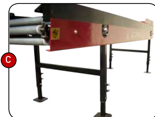
С. Опора стола регулируется по высоте, позволяя комбинировать стол с другими машинами интегрируя его в общую линию по чистки. Выгрузка чеснока возможна прямо в контейнера или же на другой вид оборудования для последующей обработки (шелушильный стол, сортировочный стол и т.д)
