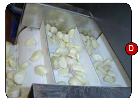
Д. Изготовлена из материалов для пищевого использования. Компоненты изготовлены исключительно из разрешенных для пищевого использования материалов, нержавеющей стали и PVC, в соответствии с нормами и требованиями ЕС.
