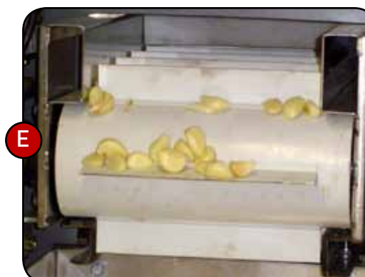
Е. Эффективность очистки 98%. Предварительное нагревание и сжатый воздух гарантируют очистку 98% зубков чеснока самых разных сортов и калибров.
